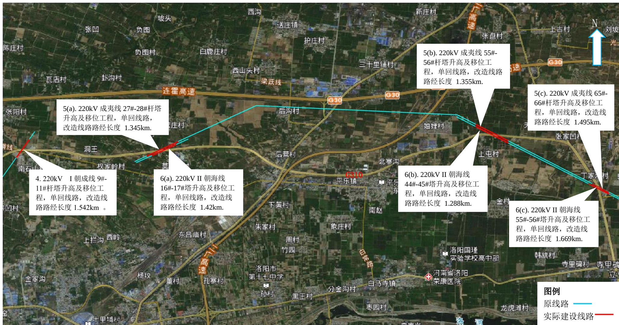
图 4-3 新 310 国道 220kV 线路迁建及杆塔升高改造工程路径示意图
