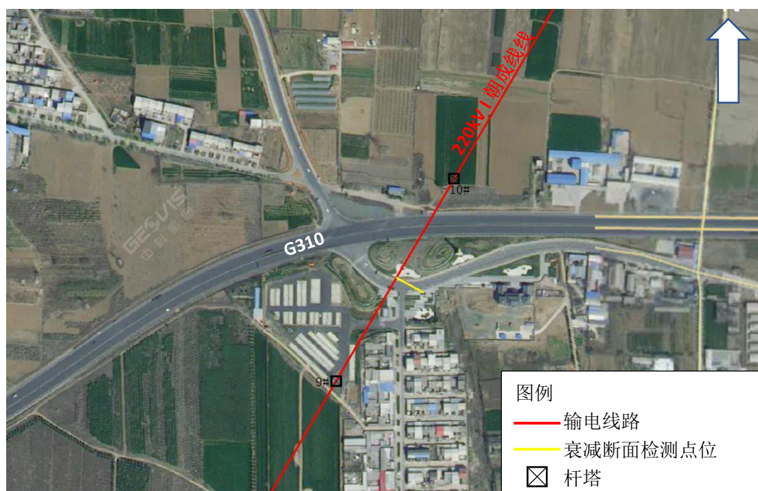
图 7-2 220kV I 朝成线衰减断面工频电磁场检测点位
