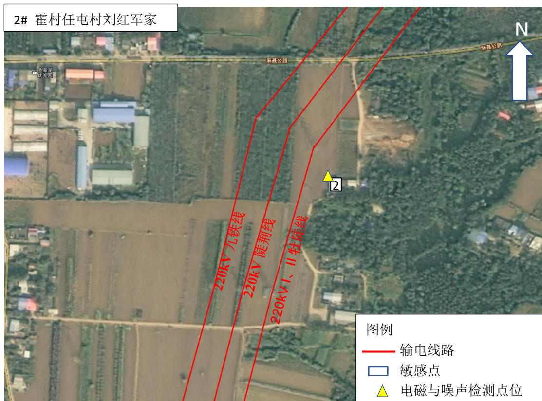
图 7-4 敏感点工频电磁场及噪声检测点位
